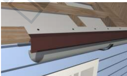
Рис.5 Схема крепления карнизной планки
